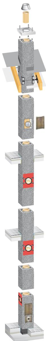
Der Schiedel SIK ist ein dreischaliges, feuchteunempfindliches Luft-Abgas-Kaminsystem mit konzentrischer Luftführung. Das System besteht aus Leichtbeton-Mantelsteinen, Keramikrohren mit Dämmschalen und vormontierten Abstandshaltern. Es ist einsetzbar für alle Brennstoffe und Feuerstätten (Abgastemperatur  $\leq 400^{\circ}\text{C}$ , Unterdruckbetrieb) im raumluftunabhängigen und raum-luftunabhängigen Betrieb.
